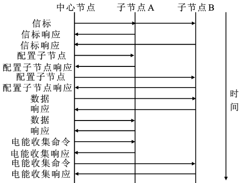
图 6 协议栈验证流程图
